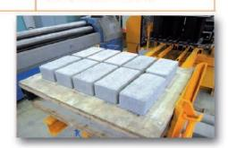
Unità Vibromobile e Statiche per la prefabbricazione di Blocchi, Pavè, Cordoli ...
