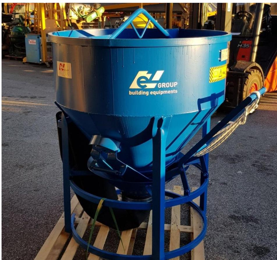
Benne à béton droite avec palonnier incorporé dans la caisse de la benne pour améliorer la sécurité sur les chantiers.
