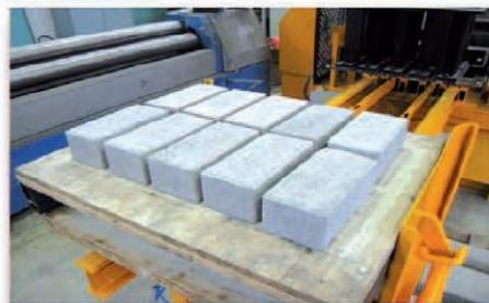
Unità Vibromobile e Statiche per la prefabbricazione di Blocchi, Pavè, Cordoli ...
